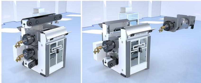
Für die Anodenherstellung kann der Kalandrier in der Linie in **Tandemausführung** aufgestellt werden, um in einem zweiten Kalandrierschritt die Elektroden nachzuverdichten. Wer flexibel bleiben möchte, um seine Maschine den zukünftigen Zelleigenschaften anpassen zu können, wählt die **hydraulische Gegenbiege-Vorrichtung**. Damit lässt sich die Durchbiegung der Walzen variabel einstellen. Jede Walze kann dabei unabhängig voneinander eingestellt werden.
